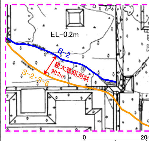
拡大図② S-2・S-6とB-2の離隔距離 (1号機基礎掘削面スケッチ)
