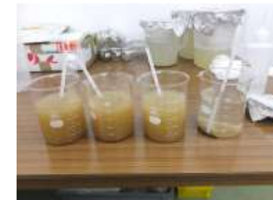
ビーカーを用いた水簸の例
