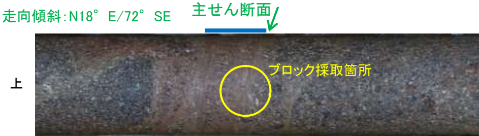
ボーリングコア写真(N-2.3-1孔)
