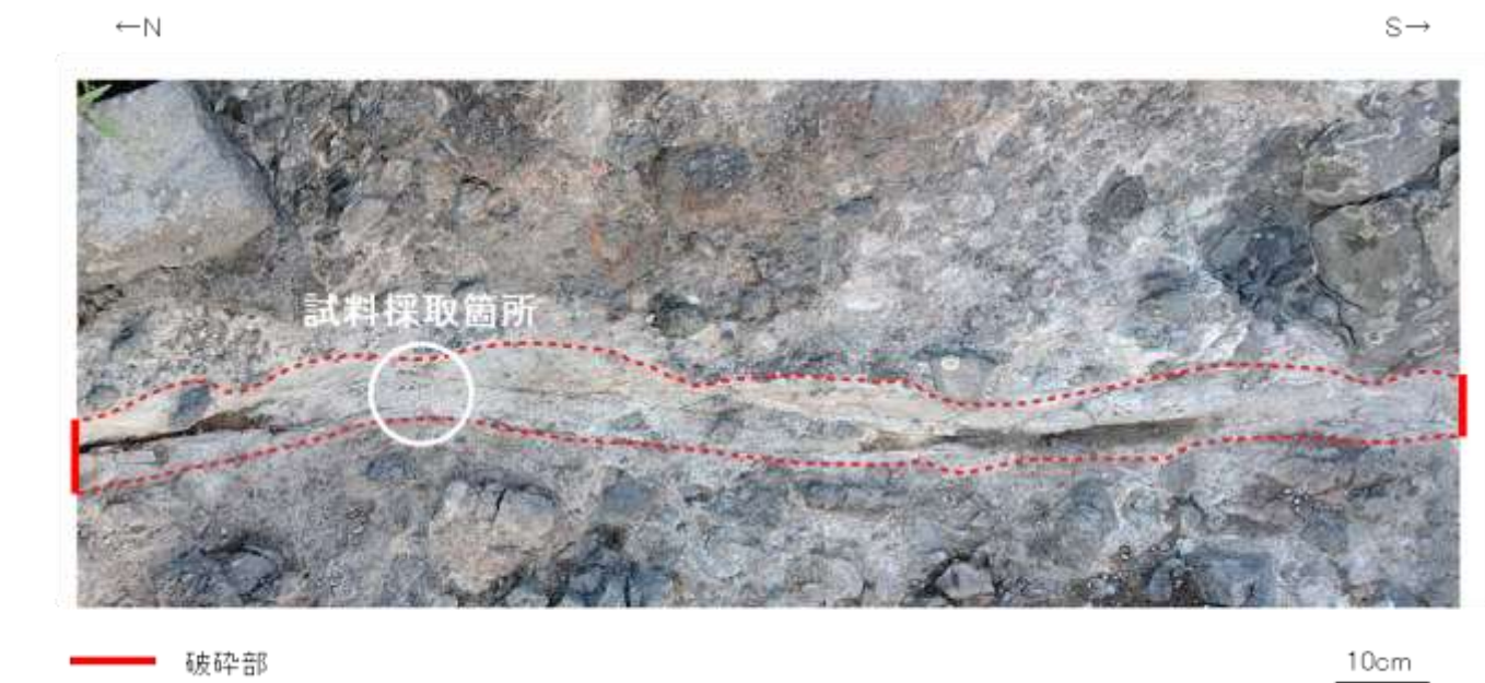
K-2露頭 a地点 破碎部の状況写真
