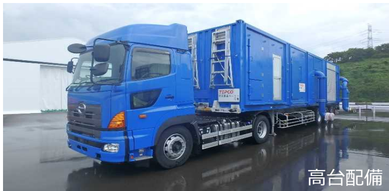
電源不要で原子炉の蒸気で原子炉に注水できるポンプ <熱交換器車>
