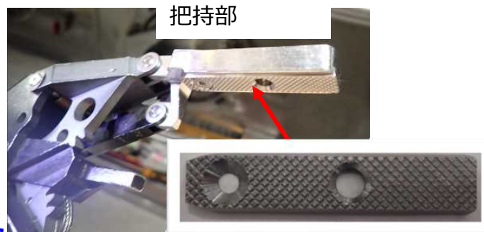
すべり止め対策として製作した爪先部品
