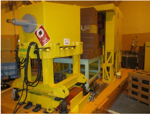
検出器回転架台
