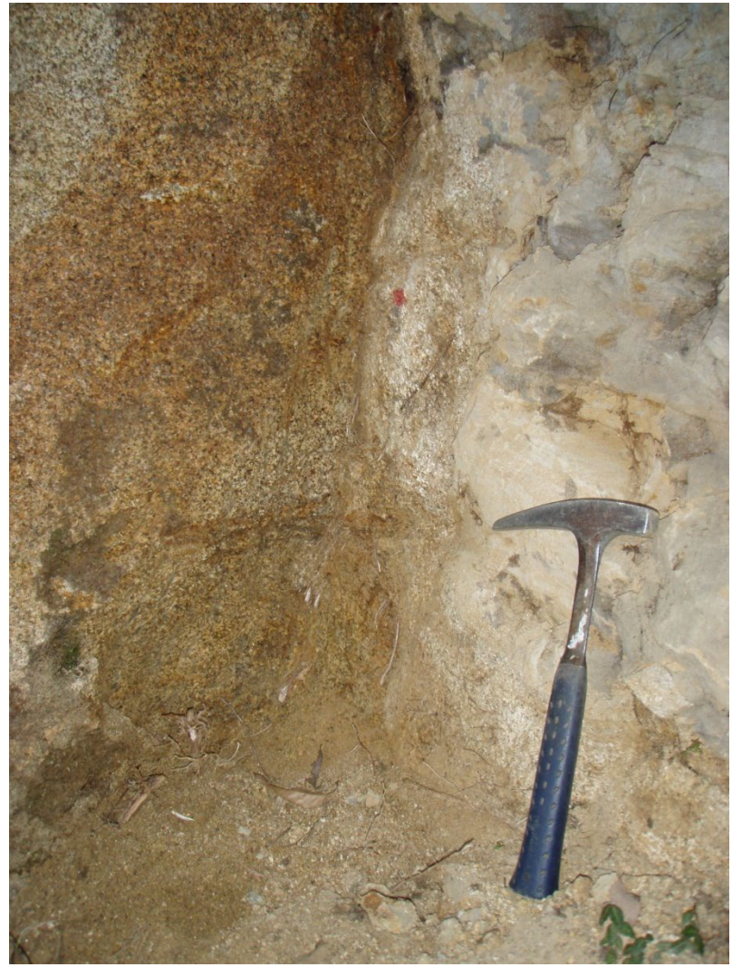
写真4 断層面の癒着した断層 (拡大)
