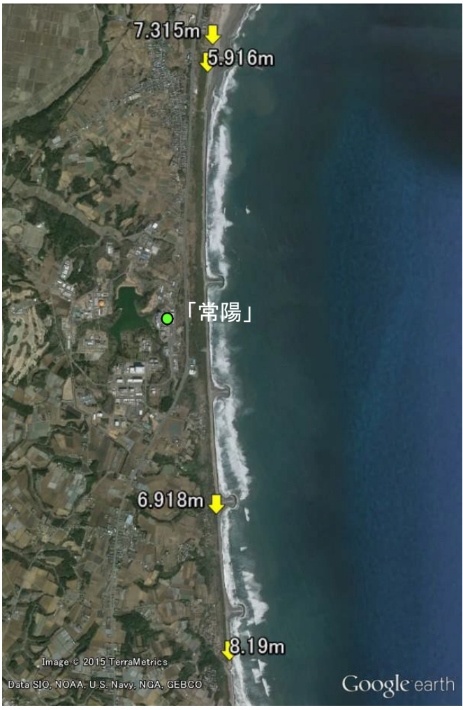
2011年東北地方太平洋沖地震津波による敷地近傍の痕跡高 (東北地方太平洋沖地震津波合同調査グループ(2011)による)
