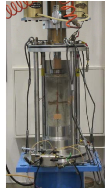
一軸圧縮試験の状況
