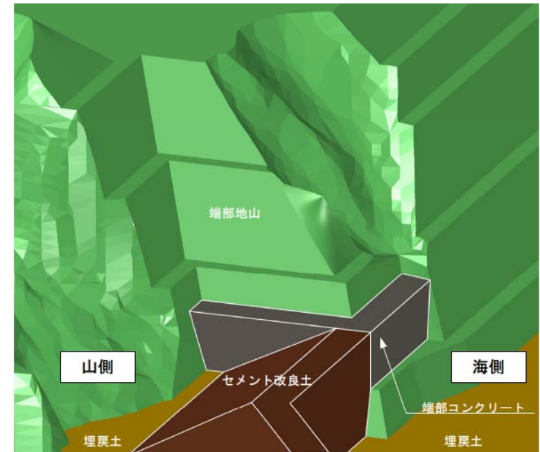
防潮堤(端部)の構造イメージ図
