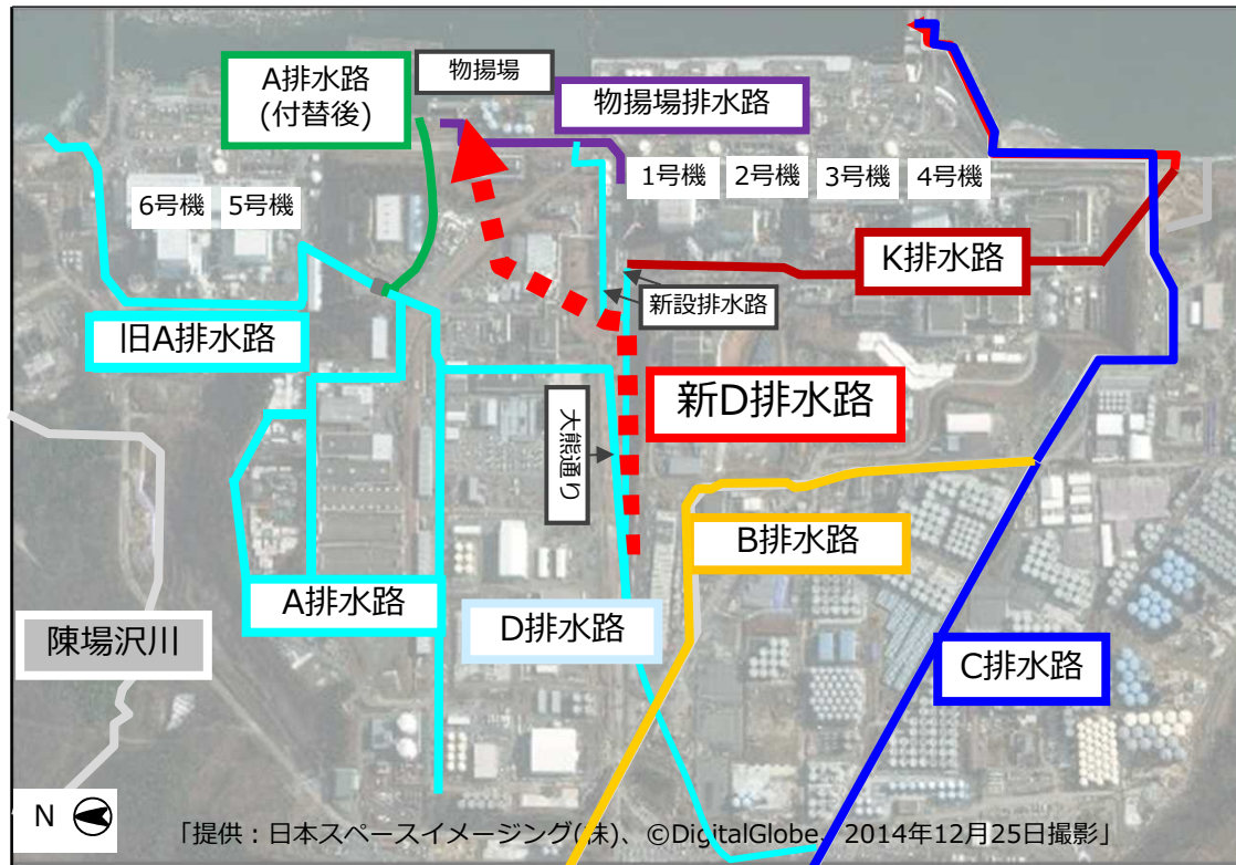
図1 構内排水概要図
