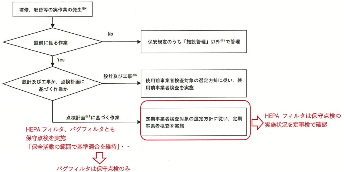
図 3-1 事業者検査に関する基本的な考え方（廃止措置段階を除く）
