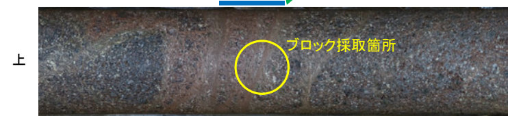
固結した破砕部 ボーリングコア写真(N-2.3-1孔)
