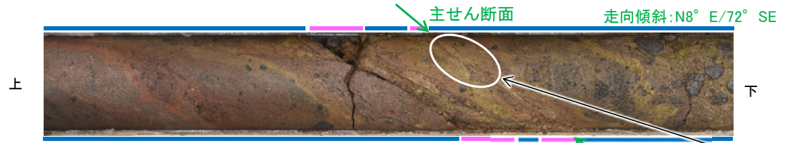
ボーリングコア写真(G-1.5-80孔)
