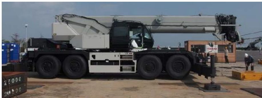
①燃料取扱機 (起伏角度0°／ブーム長さ9.8m)
