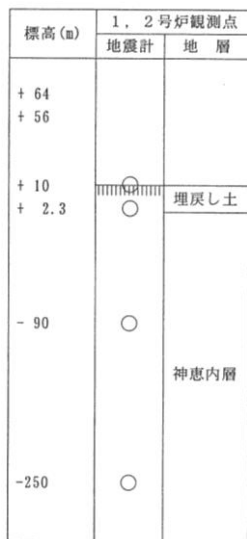
地震計の設置レベル
