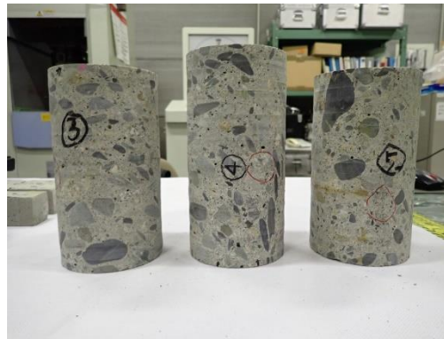
採取されたコンクリートコア
