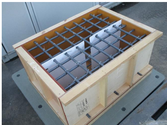
せん断試験体 打設前
