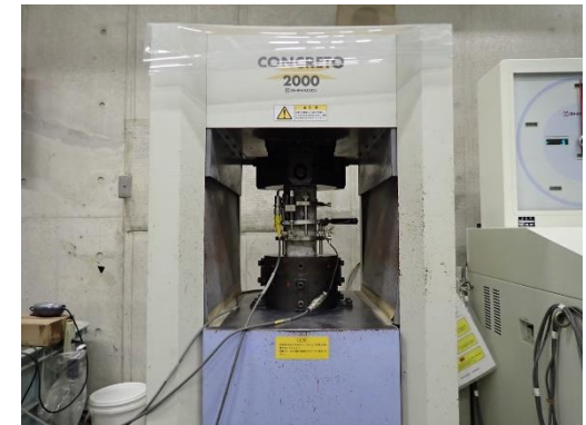
コア供試体の一軸圧縮試験
