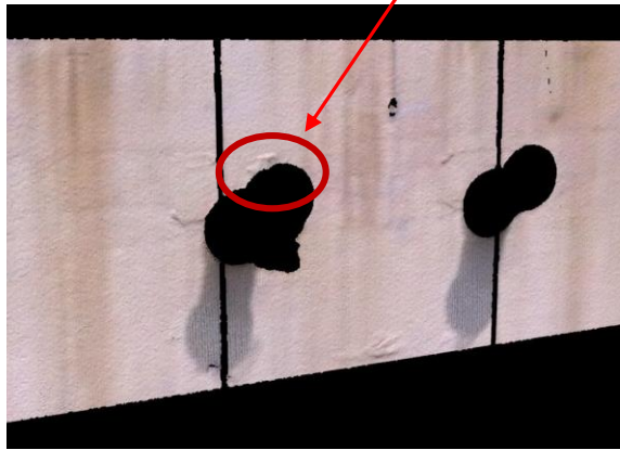
イソコン配管付近の点群データをメッシュ化
