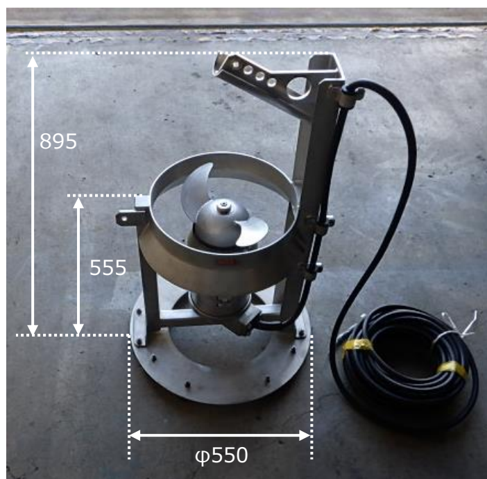
図 2.14.1-12 攪拌機器の実機と寸法
