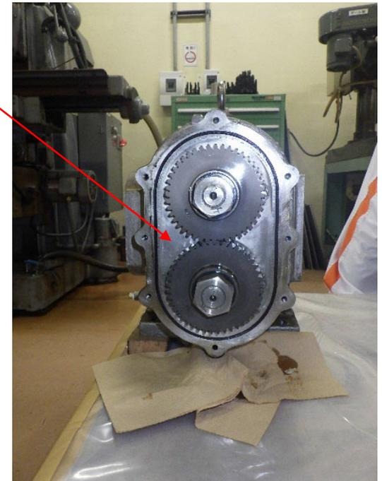
ギヤカバー取外し後の内部状況 (分解点検中)
