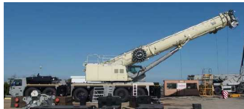
③クレーン (起伏角度24°／作業半径12.6m)
