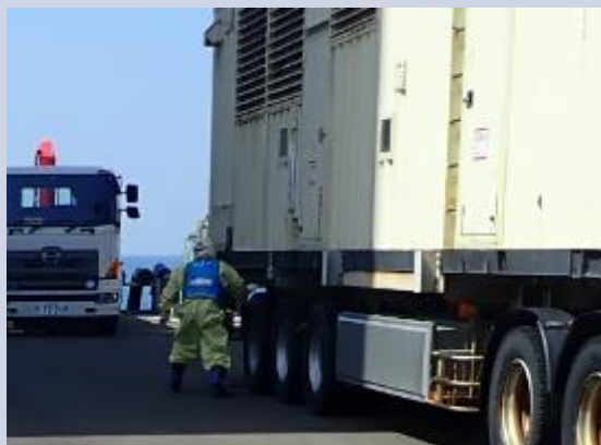
可搬型代替電源車の使用前点検
