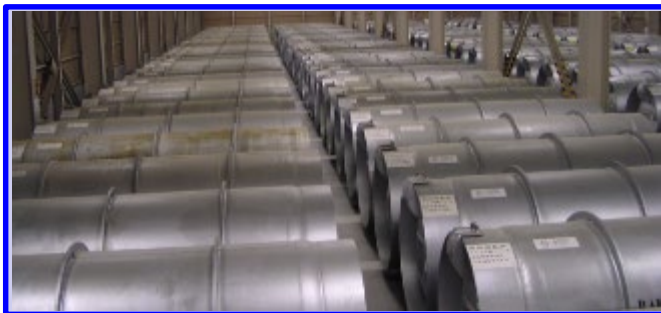
貯蔵施設内で保管管理している六フッ化ウランを収納した鋼鉄製の容器
