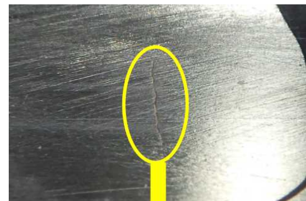
傷の代表例 (傷の長さ2.0 mm (研磨後))
