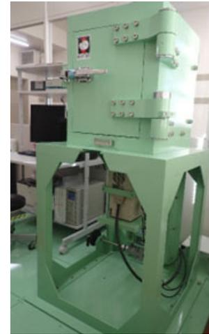
・ 約3keV から約3MeV までのエネルギーを測定可能な  $\gamma$  線検出器であり、特に低エネルギー領域において高い分解能を有する。
