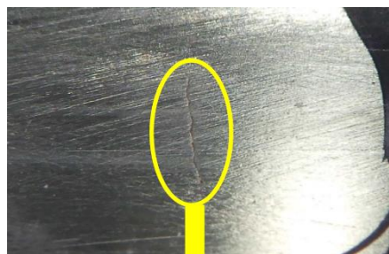
傷の長さ：2.0 mm（研磨後）
