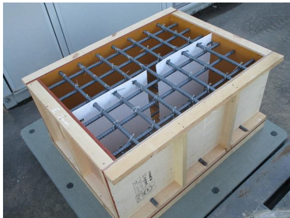
せん断試験体 打設前
