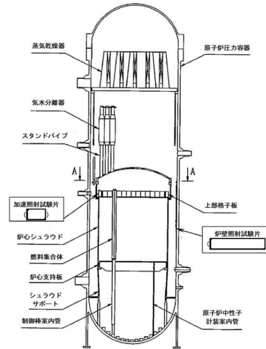
付図-1 監視試験片取付図
