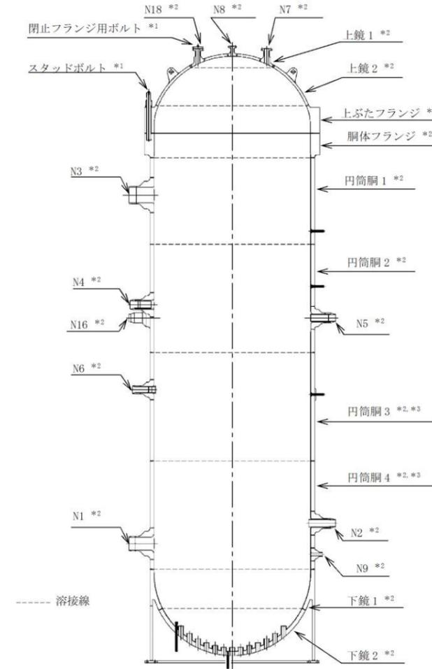
注記\*1: 最低使用温度を基準とする評価箇所
