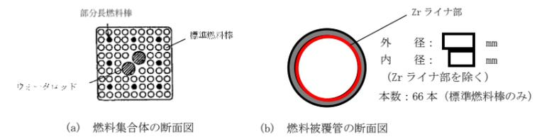
図 5-6 燃料集合体の断面図
