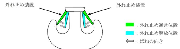
図 3-4 フックの外れ止め装置
