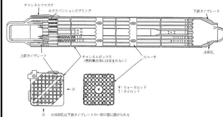
図5-1 燃料集合体の概要 (高燃焼度 8×8 燃料)
