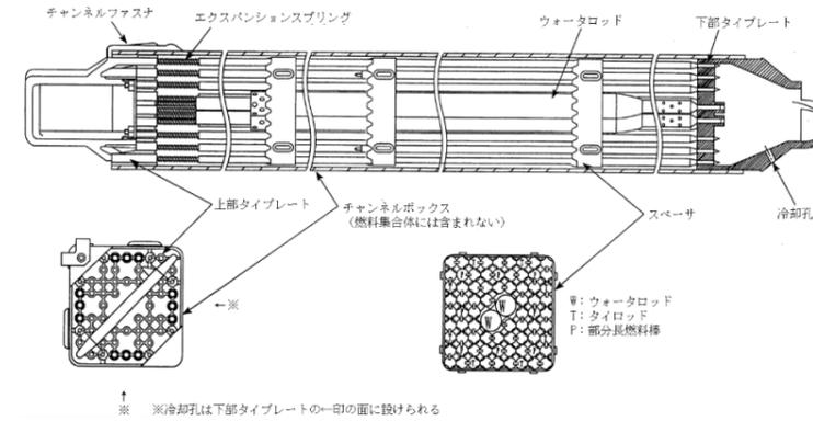
図 5-2 燃料集合体の概要 (9×9 燃料 (A 型))
