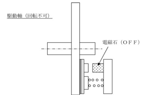
図 3-3 電磁ブレーキの動作原理
