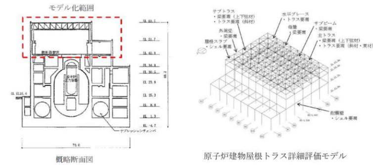
図 4-2 原子炉建物屋根評価モデル
