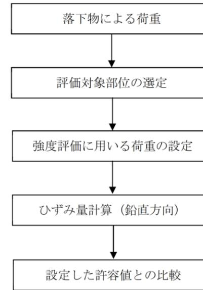
図 5-4 燃料集合体の強度評価フロー
