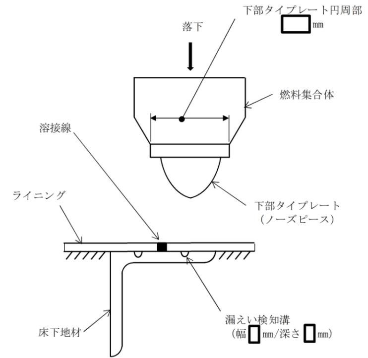
図 3-1 漏えい検知溝上への燃料集合体の落下
