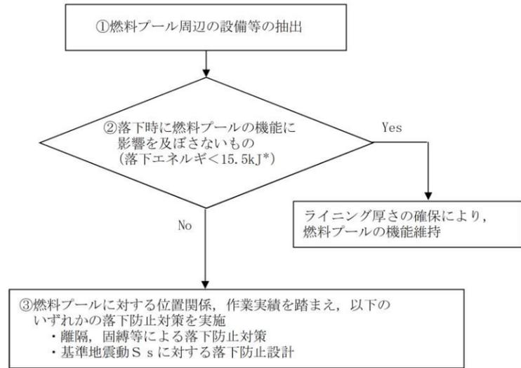
注記\* : 落下試験時の模擬燃料集合体の落下エネルギー
