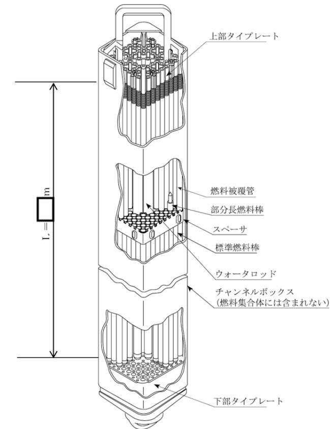
図 5-5 燃料集合体の構造図
