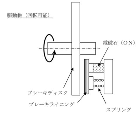
【巻上げ機停止時 (電源遮断時) の状態】
