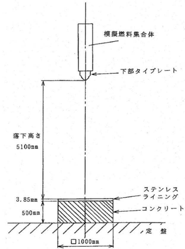
図1-1 模擬燃料集合体落下試験方法
