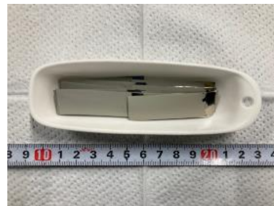
試験後 (200°C水蒸気環境下)
