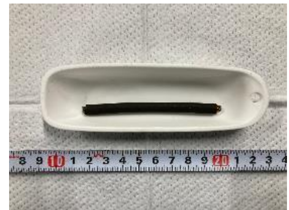
試験後 (200°C水蒸気環境下)
