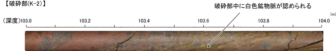
破碎部中に白色鉱物(オパールCT)の鉱物脈が認められる事例 (試料viii. H-1.1孔 深度103.62m付近)
