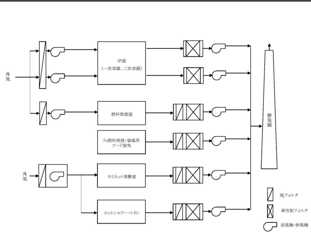
図10-1 気体廃棄物の廃棄設備の系統図
