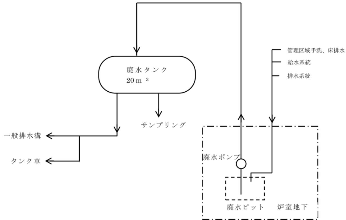
図10-2 液体廃棄物の廃棄設備の系統図
