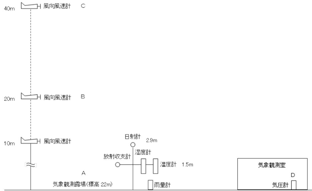
図3-2 気象観測設備配置図（その2）
