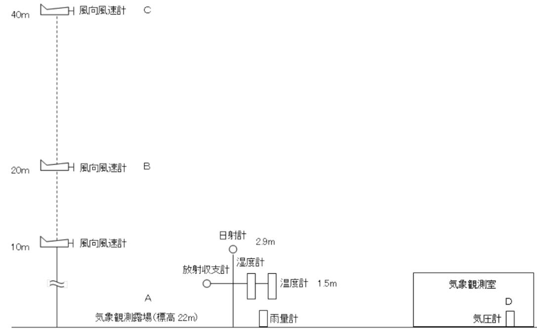
図4-2 気象観測設備配置図（その2）
