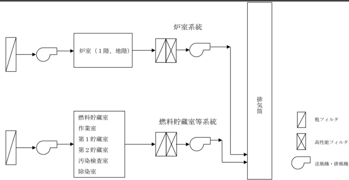
図10-1 気体廃棄物の廃棄設備の系統図
