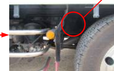
固縛用リング取付箇所
