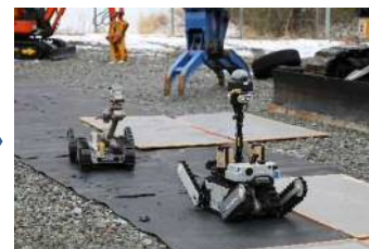
ロボットによる線量確認
