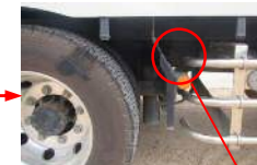
固縛用リング取付箇所
