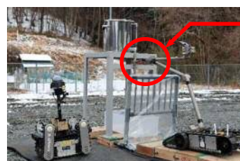
ロボットによるタンクの水抜き
