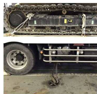
船内25t車両固縛状態(一部)
