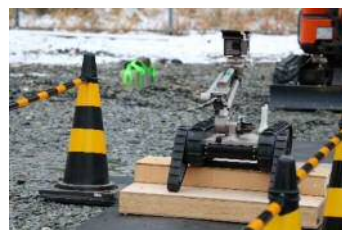
ロボットの通路侵入（段差超え）
