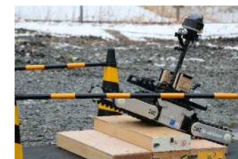
ロボットの通路侵入（段差超え）
