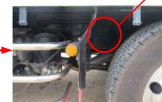
片側面3ヵ所 固縛用リング取付け (両側 … 計:6箇所)
