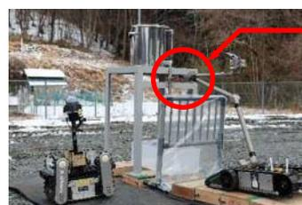
ロボットによるタンクの水抜き
