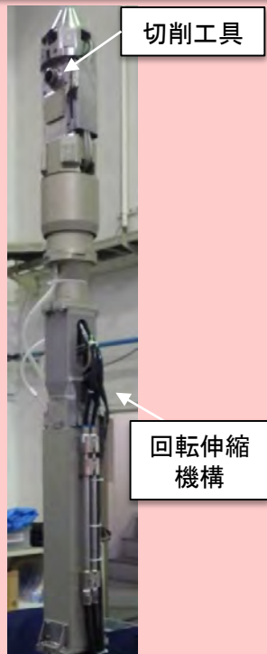
下部挿入型試料採取装置 (圧力管・カランドリア管用)
