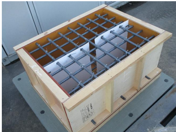
せん断試験体 打設前
