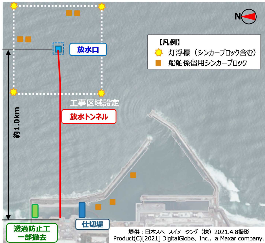
図 2.9.8-9 海上工事概要図（平面）
