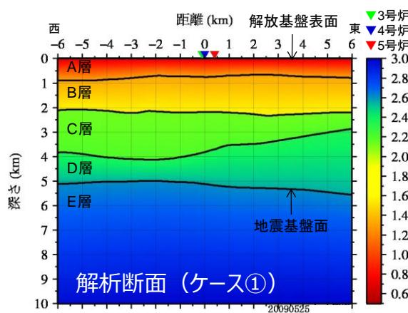
○作成した深部三次元地下構造モデルの代表的な4方向を解析断面として、二次元有限差分法により、3～5号炉位置の地盤增幅特性に係る解析検討を行った結果、
