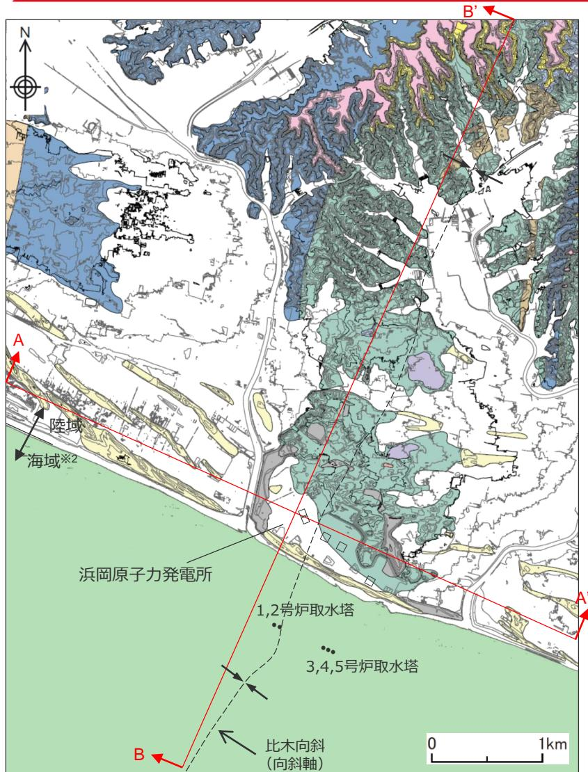
○敷地の基盤を構成する相良層群相良層は砂岩・泥岩互層として一様に分布し、2号炉と3号炉の間には北北東－南南西に軸を持つ向斜構造（比木向斜）が認められる。
