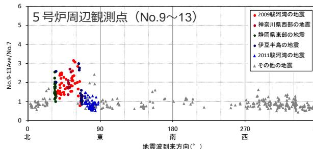
&lt;各地震の振幅比（No.7基準）と地震波到来方向との関係（水平平均）&gt;
