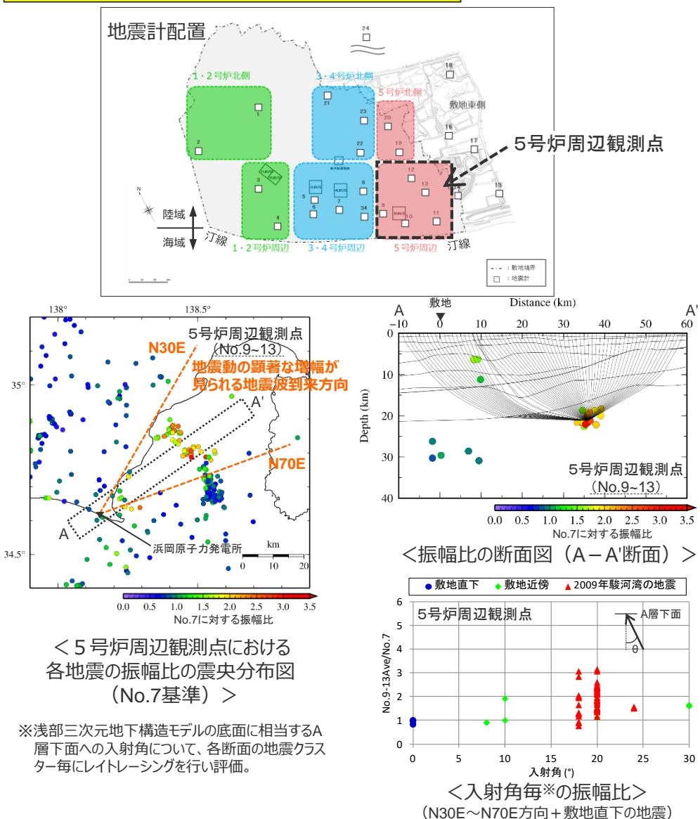
※浅部三次元地下構造モデルの底面に相当するA層下面への入射角について、各断面の地震クラスター毎にレイトレーシングを行い評価。
