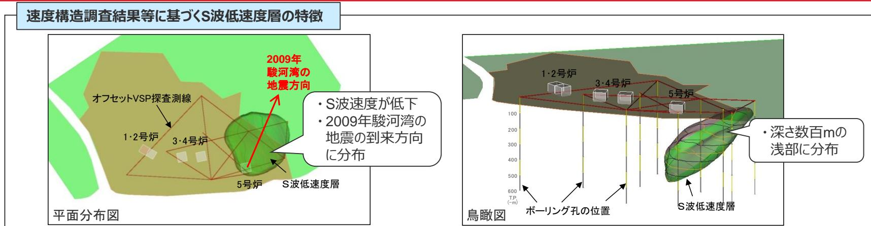
「速度構造調査結果等に基づくS波低速度層の特徴」は、「地震観測記録に基づく5号炉周辺の増幅要因の考察」と整合していることから、S波低速度層が5号炉周辺の増幅要因であると推定される。
