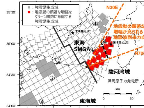
増幅係数を乗じる強震動生成域（アスペリティ）を「増幅方向」の敷地近傍に配置したうえで保守的な評価を行うため、「増幅方向」に位置する背景領域は、敷地から離れており地震動評価結果に及ぼす影響は「増幅方向」の敷地近傍に配置した強震動生成域（アスペリティ）に比べて小さいと考えられる。（→念のため、「増幅方向」に位置する背景領域の小断層にも増幅係数を乗じた場合の影響確認を行う。）
