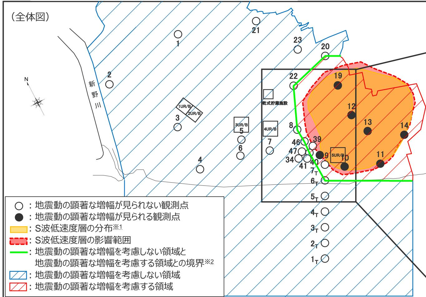
※1 S波低速度層の分布は、敷地近傍の複数の速度構造調査結果（オフセットVSP探査）に基づき推定。その速度構造調査結果に関し、チェックボードテスト及びスパイクテストにより信頼性を確認（詳細は補足説明資料①-04参照）。
