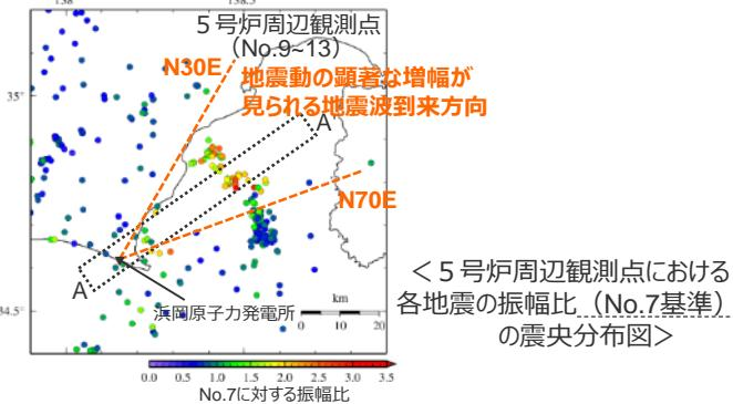
&lt;5号炉周辺観測点における各地震の振幅比（No.7基準）の震央分布図&gt;
