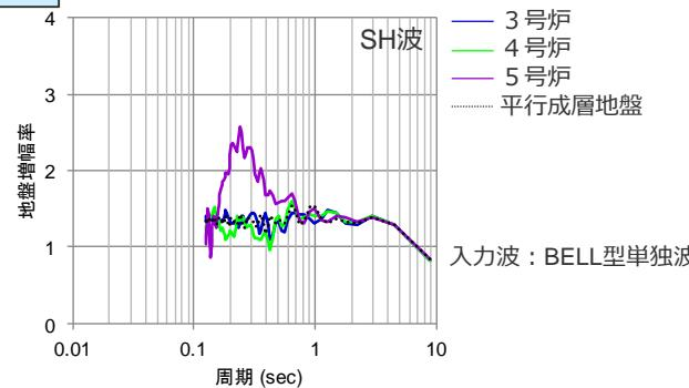
&lt;3～5号炉位置の地盤増幅率（入射：2009年駿河湾の地震方向）&gt;
