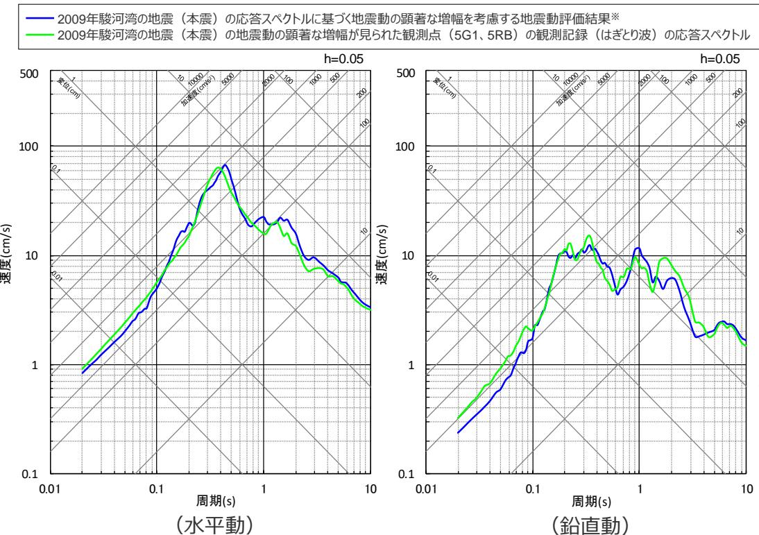
※ 2009年駿河湾の地震（本震）の地震動の顕著な増幅が見られなかった観測点（3G1、4G1）の観測記録（はぎとり波）の応答スペクトルに、断層モデルを用いた手法による地震動評価結果に基づく増幅係数（応答スペクトル比）を乗じて算出。
