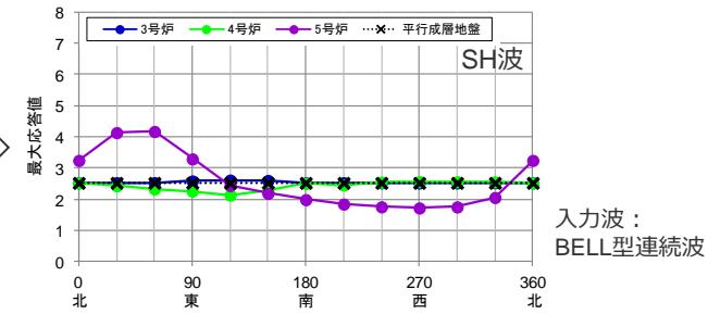
&lt;3～5号炉位置の応答波形の最大値分布（入射：各方向）&gt;
