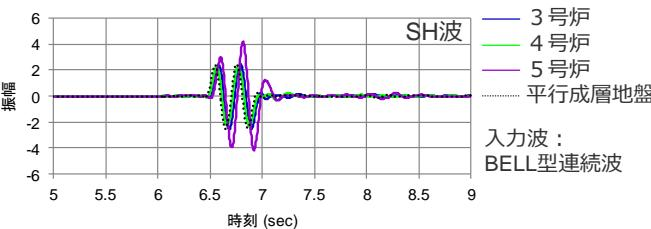
&lt;3～5号炉位置の応答波形（入射：2009年駿河湾の地震方向）&gt;
