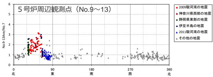
&lt;各地震の振幅比 (No.7基準) と地震波到来方向との関係 (水平平均) &gt;
