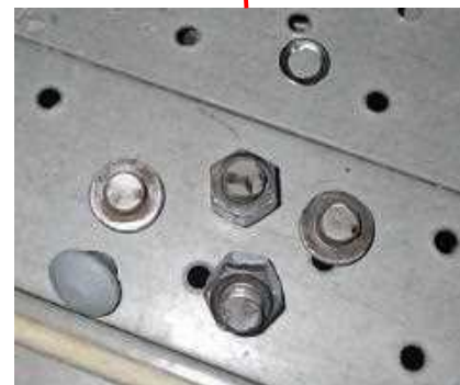
接合部のボルトが破断
