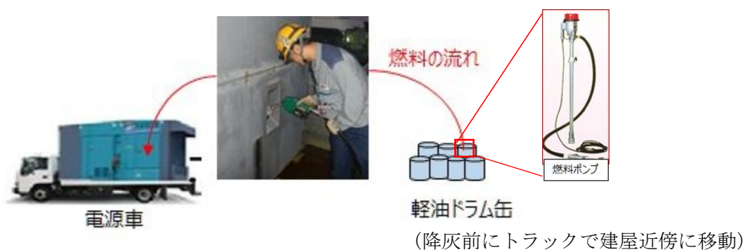
図 3. 3. 1 軽油ドラム缶から電源車への燃料補給実施概要図
