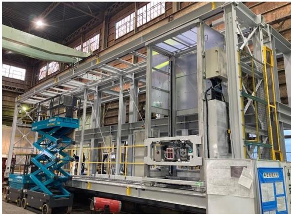
アンカー削孔装置フレーム
