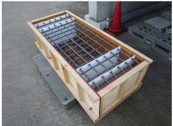
引抜試験体 打設前
