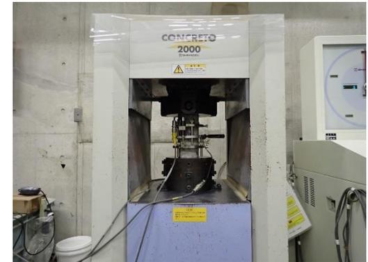
コア供試体の一軸圧縮試験
