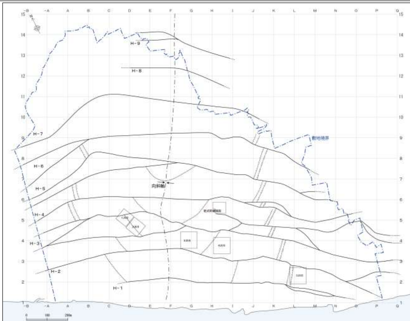
地質水平断面図（T.P.-13.5m）
