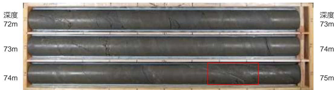
コア写真（赤枠部でブロック試料を作成）
