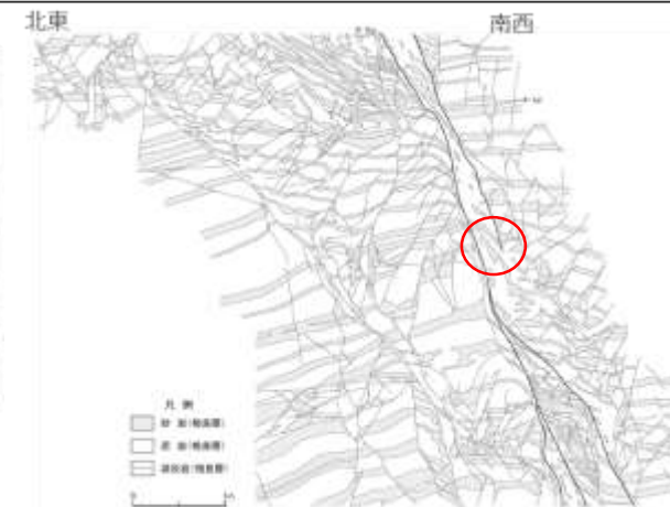
細粒物質を伴う断層が不明瞭なH断層の例 H-5断層 (GTG建屋南側法面(西面))
