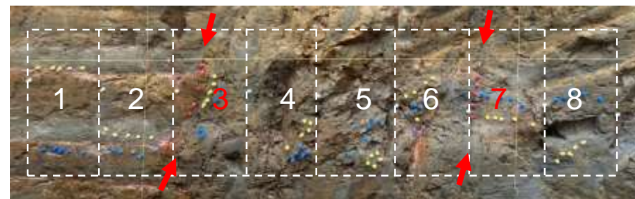
測定面の設定状況 (数字は測定面番号, 赤い数字の測定面は細粒物質を含む測定面を表す。)
