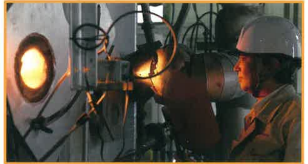
石炭燃焼特性実証試験装置
