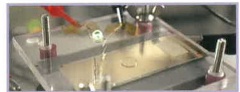
電気二重層エレクトレットを利用した振動発電素子
