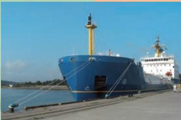
海外から輸送される際は、実績のある放射性物質専用輸送船が使用されます。万一の衝突などを考慮した船体の二重構造や衝突防止システム、さらに防火設備など、十分な安全対策が講じられています。
