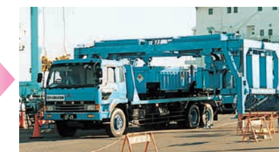
ゲートモニターにより線量当量率の測定
