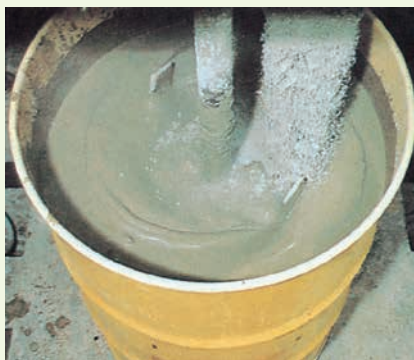
濃縮された廃液をセメントで固型化したもの
