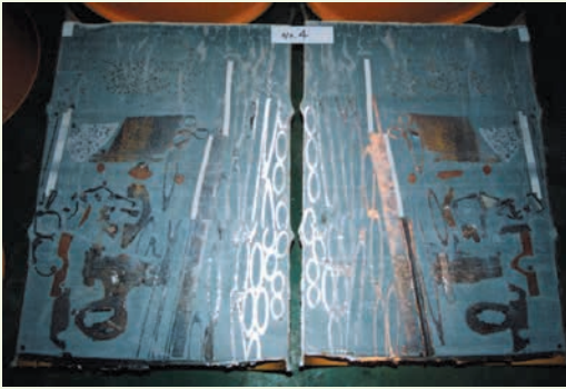
金属類等を収納し、セメント系充てん材（モルタル）で一体となるよう固型化したもの
