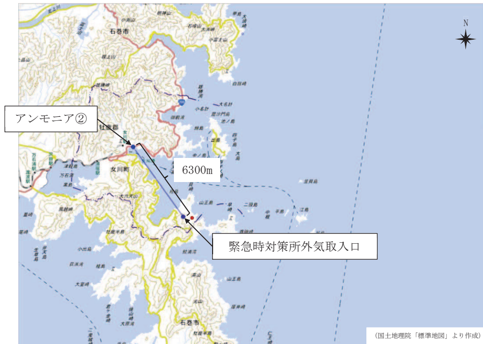
図 12 アンモニア②と緊急時対策所外気取入口との距離の評価結果
