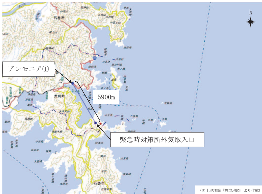
図 11 アンモニア①と緊急時対策所外気取入口との距離の評価結果
