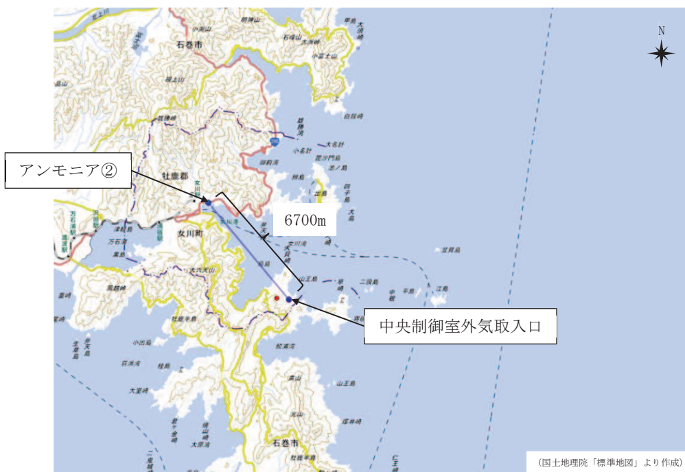
図8 アンモニア②と中央制御室外気取入口との距離の評価結果
