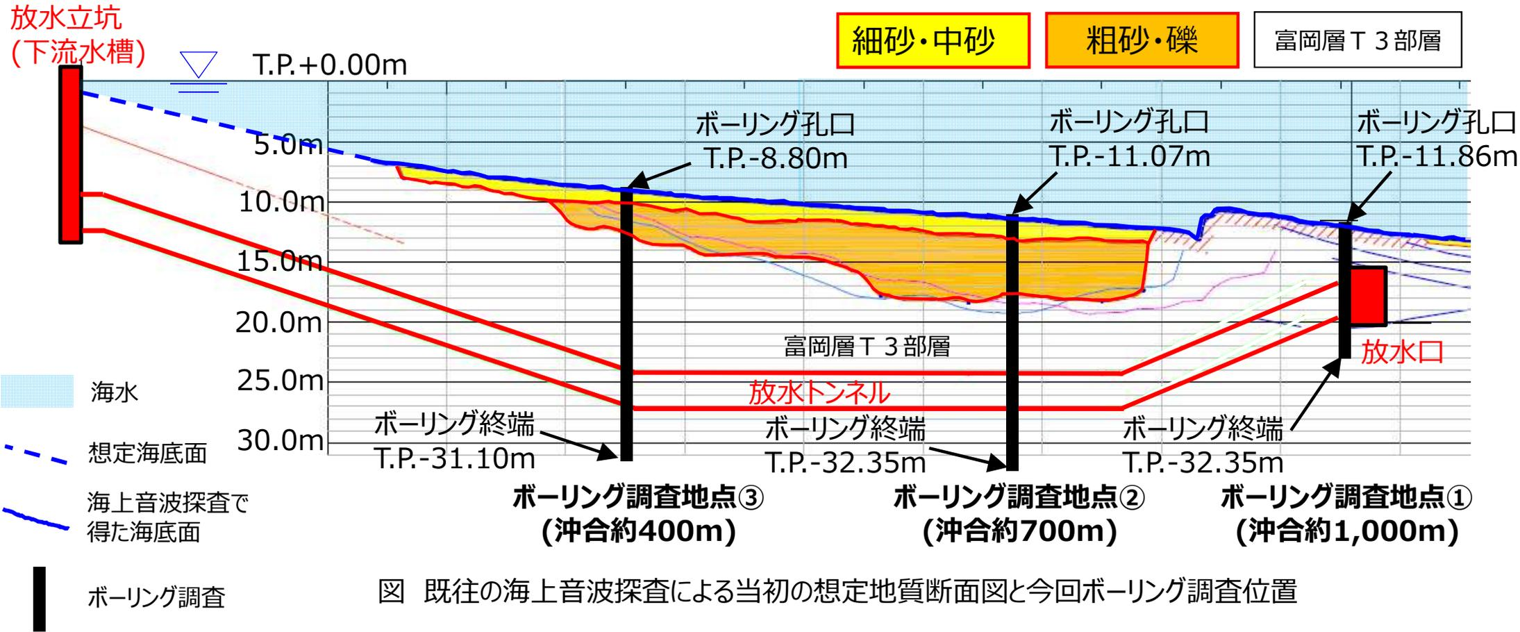
図 既往の海上音波探査による当初の想定地質断面図と今回ボーリング調査位置
