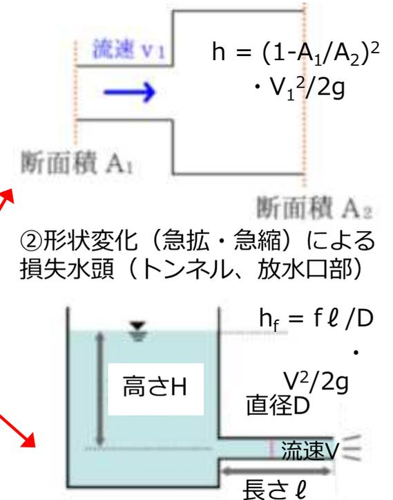
②形状変化（急拡・急縮）による損失水頭（トンネル、放水口部）
