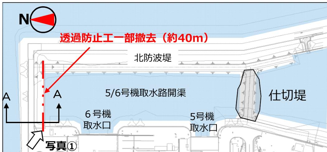
仕切堤構築平面図
