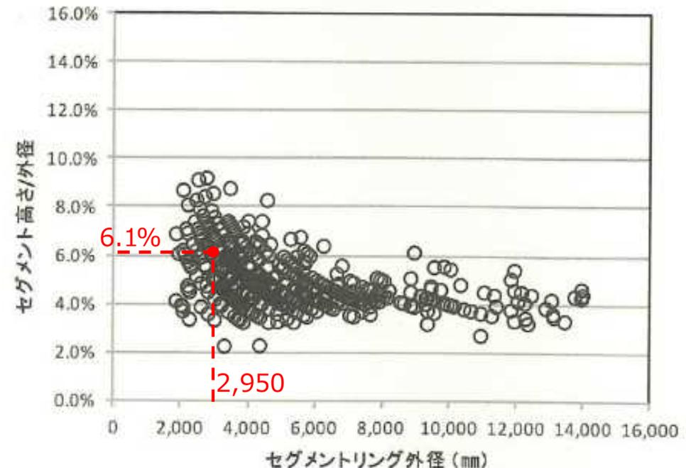
セグメント高さ(厚さ)/外径と外径 散布図※)
