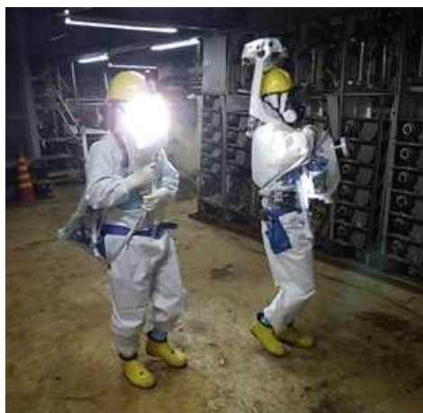
ウェアラブル型3Dスキャン装置 （4号機におけるモックアップの様子）
