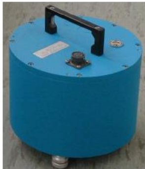
地震計LE-3D/5S レナーツ社(独) http://www.lennartz-electronic.de/
