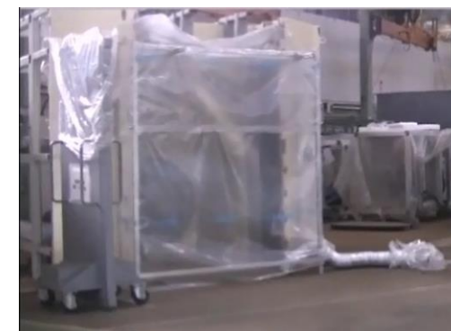
ダスト対策養生 (簡易ハウス)
