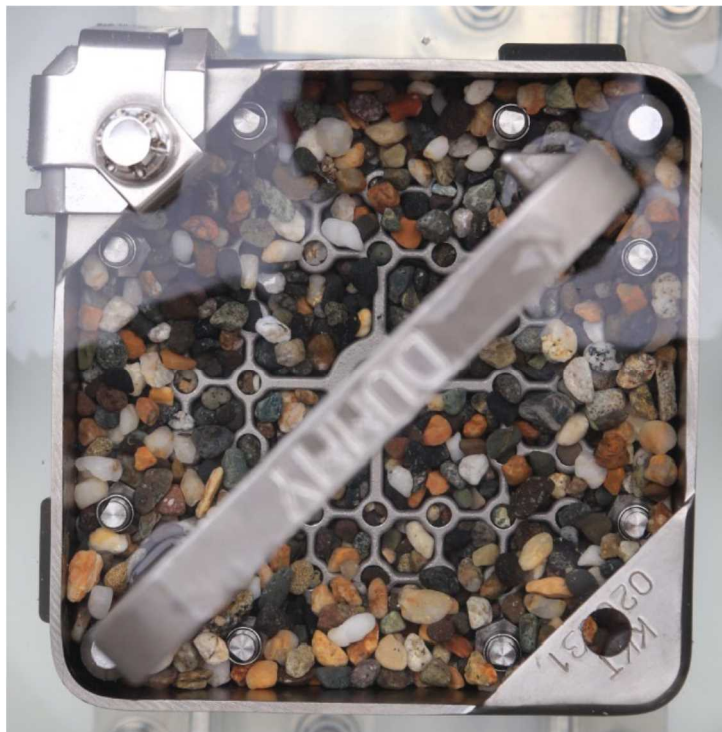
試験前 燃料集合体上部 (ダミー燃料)
